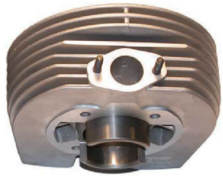
Ailette usinée au-dessus de l'admission
