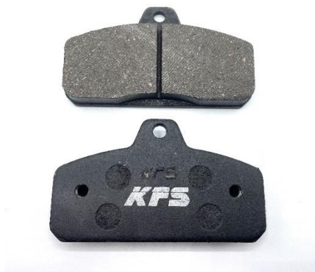
Plaquettes pour frein mécanique Epaisseur d'origine 13,5 mm
