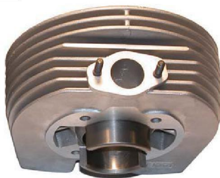
Ailette usinée au-dessus de l'admission
