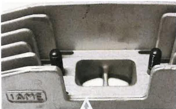
Plan de joint d'échappement et lumière sur aluminium brut de fonderie sablé
