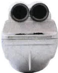
Les pipes d'entrée d'air doivent être dirigées vers l'avant du kart.
